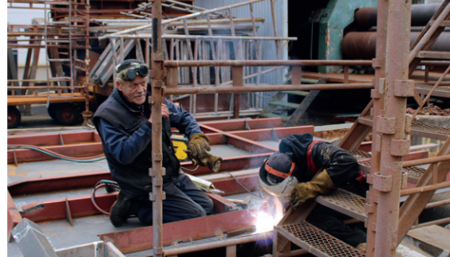
▲ När man har tid över arbetar man med underhållsarbete, här bygger gubbarna en ny lucka till en av flytdockorna.
